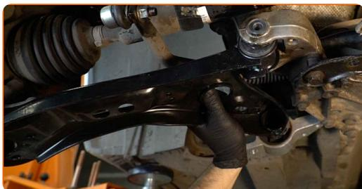
Remplacement : bras inférieur avant – SKODA SUPERB Break (3T5). AUTODOC recommande :
