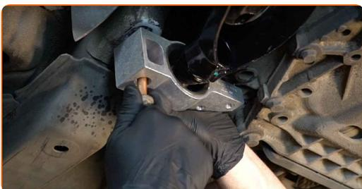
**18** Vissez la fixation arrière reliant le bras de suspension à la carrosserie. Utilisez une clé mixte de No.18 Utilisez une douille n° 18. Utilisez une clé à cliquet.
