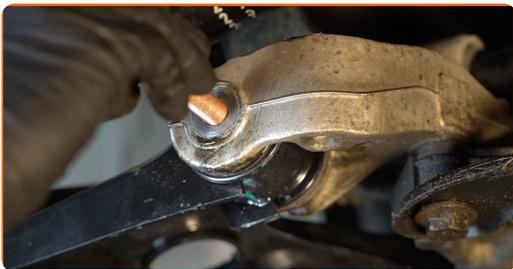
**16** Vissez les fixations de la rotule. Utilisez une douille n° 16. Utilisez une clé à cliquet.
