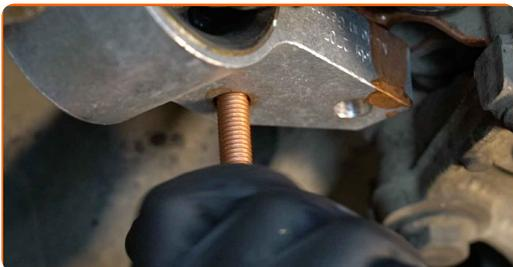
**20** Vissez la fixation arrière reliant le bras de suspension au cadre auxiliaire. Utilisez une clé mixte de No.16 Utilisez une douille n° 16. Utilisez une clé à cliquet.
