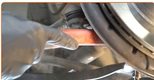
**7** Dévissez l'écrou d'attache d'extrémité à la fusée d'essieu. Utilisez une douille n° 18. Utilisez un porte-taraud.
