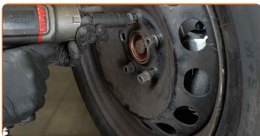
**24** Abaissez la voiture et serrez les boulons de roue en ordre croisé. Servez-vous d'une douille à choc pour roue N°17. Utilisez une clé dynamométrique. Serrez-le jusqu'à 120 Nm.
