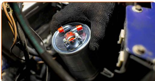
Remplacement : filtre à carburant – SKODA SUPERB Break (3V5). Les experts d'AUTODOC recommandent :
