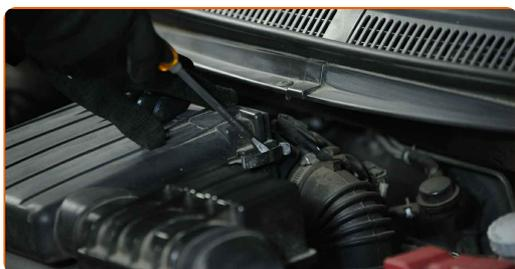
**4** Dévissez la fixation du compartiment du filtre à air. Utilisez une douille n° 10. Utilisez une clé à cliquet.
