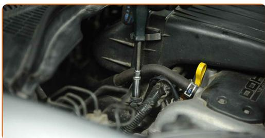
**5** Déconnectez le tuyau d'admission d'air du boîtier du filtre à air.
