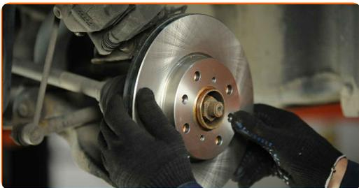
**21** Serrez l'attache du disque de frein. Utilisez la mèche Torx T30. Utilisez une clé dynamométrique. Serrez-le jusqu'à 9 Nm.
