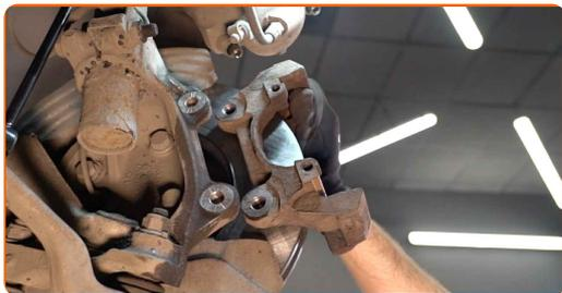
**30** Installez les boulons de fixation (2 pièces).
