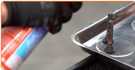
**25** Appliquez du produit sur les boulons de guidage de l'étrier de frein. Appliquez la graisse pour les boulons de guidage de l'étrier de frein.
