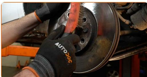
**17** Dévissez l'attache du disque de frein. Utilisez la mèche Torx T30. Utilisez une clé à cliquet.
