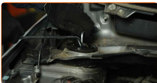
**46** Installez le bouchon de protection sur le support de l'amortisseur.
