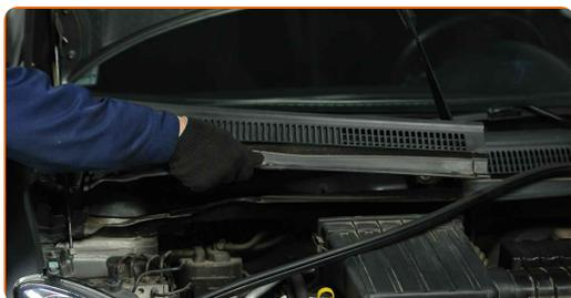
**48** Installez les fixations sur le cache d'auvent.
