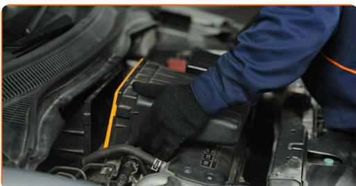
**7** Dévissez les attaches du cache moteur. Utilisez une douille n° 8. Utilisez une clé à cliquet.
