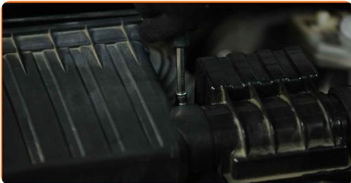
**28** Appuyez sur les clips du couvercle du filtre à air pour les remettre en place.
