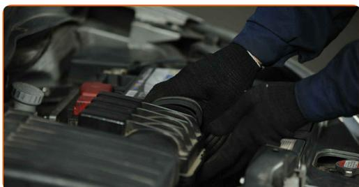
**27** CVissez les boulons de fixation du compartiment filtre. Utilisez une douille n° 10. Utilisez une clé à cliquet.
