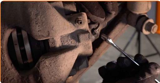
**19** Installez la conduite de frein sur le support de montage. Attachez le nouveau flexible de frein.
