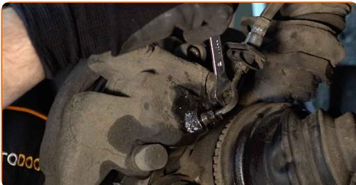
11 Dévissez la connexion reliant le tuyau de frein à la conduite du circuit de frein. Utilisez une clé mixte de No.10
