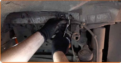
12 Retirez le flexible de frein assemblé avec le support de montage.
