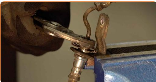
15 Retirez la conduite de freinage du support de montage.
