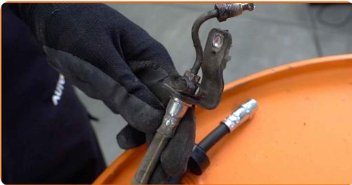
13 Resserrez dans l'étau le support de montage de l'étrier de frein.
