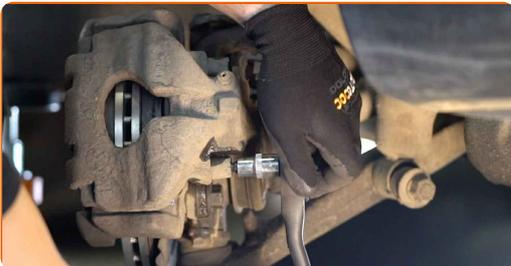
29 Installez les bouchons anti-poussière des goupilles de guidage de l'étrier de frein.
