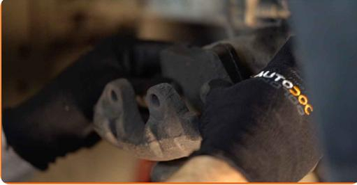
28 Installez l'étrier de frein et fixez-le. Utilisez la clé HEX n° H7. Utilisez une clé dynamométrique. Serrez-le jusqu'à 35 Nm.
