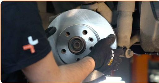
21 Serrez l'attache du disque de frein. Utilisez la clé HEX n° H6. Utilisez une clé dynamométrique. Serrez-le jusqu'à 9 Nm.
