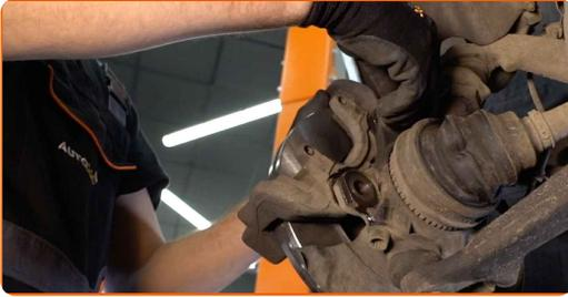
24 Serrez le support de l'étrier de frein. Utilisez une douille n° 21. Utilisez une clé dynamométrique. Serrez-le jusqu'à 180 Nm.
