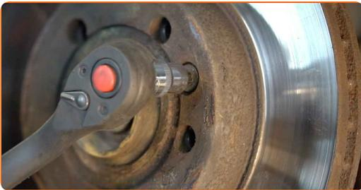
Remplacement : disques de frein – VW Transporter T4. AUTODOC recommande :
