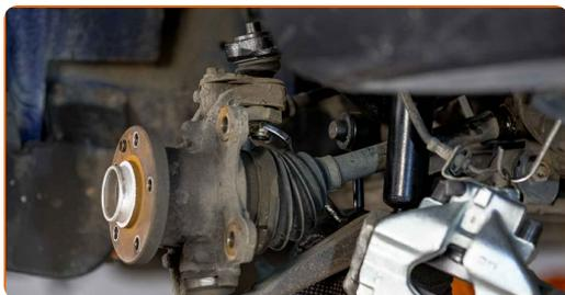
**17** Dévissez le joint rotule inférieur de la fusée d'essieu. Servez vous de la douille XZN n°14. Utilisez une clé à cliquet.
