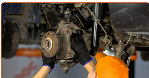
**30** Connectez le joint rotule à la fusée d'essieu. Utilisez un tournevis plat.
