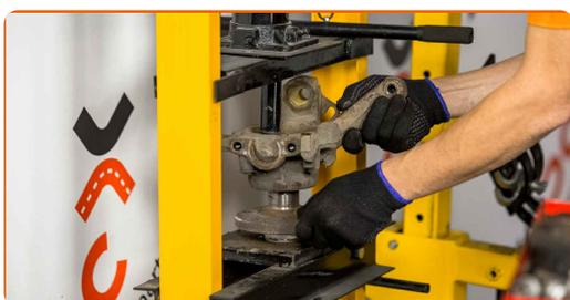
**29** Installez la fusée d'essieu et moyeu dans l'assemblage.
