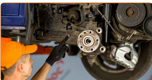
**20** Dévissez l'écrou d'attache d'extrémité à la fusée d'essieu. Utilisez une douille n° 19. Utilisez une clé à cliquet. Utilisez un porte-taroud.
