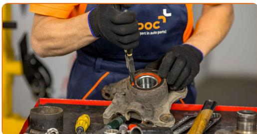
**28** Pressez le moyeu de roue dans la bague de roulement intérieure. Servez-vous d'un coffret de douilles et de roulements.
