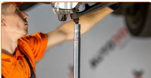
**30** Serrez l'attache de la sous-structure. Utilisez une douille n° 21. Utilisez une clé à cliquet.
