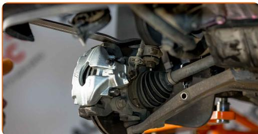
**15** Desserrez l'attache de la sous-structure. Utilisez une douille n° 18. Utilisez une clé à cliquet.
