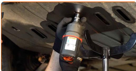
**5** Retirez le carénage sous moteur.
