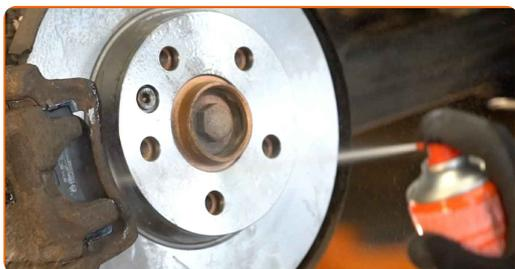
Remplacement : plaquettes de frein – VW Transporter T4. Les experts d'AUTODOC recommandent :
