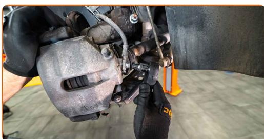
**12** Retirez les bouchons anti-poussière des goupilles de guidage de l'étrier de frein.
