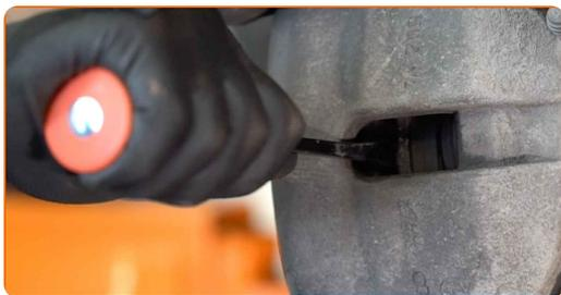
**14** A l'aide d'un simple tournevis, retirez le clip ressort de l'étrier de frein.
