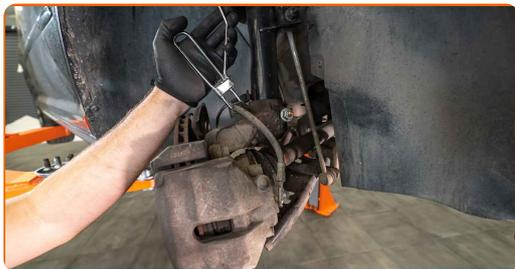
**11.2** Dévissez le flexible de l'étrier de frein. Utilisez une douille n° 11. Utilisez une clé à cliquet. Mettez le flexible de frein de côté. Attachez le flexible à la carrosserie avec un crochet ou un fil.
