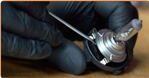
Remplacement : ampoule de phare – VW Touran 1T3. AUTODOC recommande :
