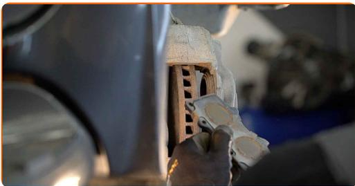
Remplacement : plaquettes de frein – TOYOTA 4Runner SUV (N210). Les experts d'AUTODOC recommandent :
