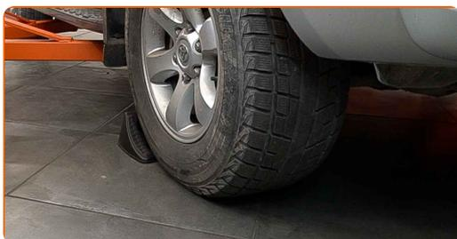
**3** Desserrez les boulons de fixation de la roue. Servez-vous d'une douille à choc pour roue N°21.
