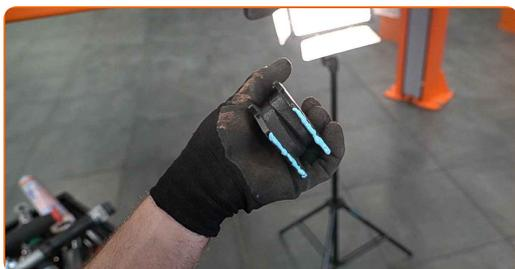
Remplacement : plaquettes de frein – TOYOTA 4Runner SUV (N210). Les professionnels recommandent :
