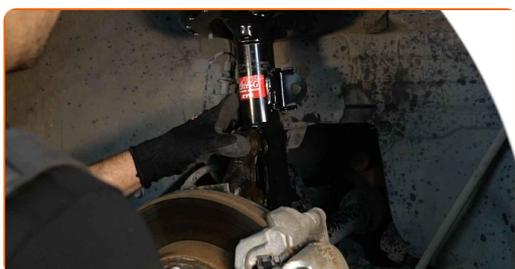
**43** Installez les boulons de fixation.
