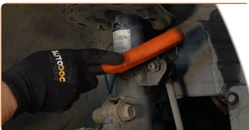
**11** Déconnectez les câbles et le flexible de frein du support sur l'entretoise de l'amortisseur. Utilisez une douille n° 14. Utilisez une clé à cliquet.
