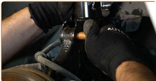
**44** Vissez la fixation qui relie la jambe d'amortisseur à la fusée d'essieu. Utilisez une clé mixte de No.22. Utilisez une douille n° 22.
