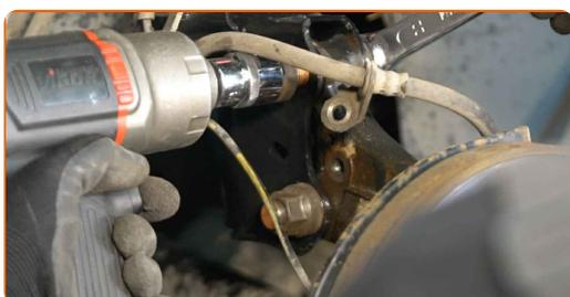
**45** Serrez les fixations inférieures qui relient l'amortisseur à la fusée d'essieu. Utilisez une douille n° 22. Utilisez une clé dynamométrique. Serrez-le jusqu'à 240 Nm.
