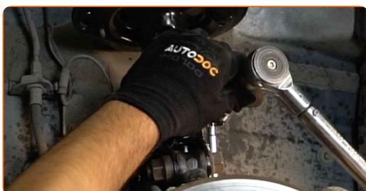
**50** Appliquez du produit sur les fixations de l'amortisseur. Utilisez de la graisse au cuivre.
