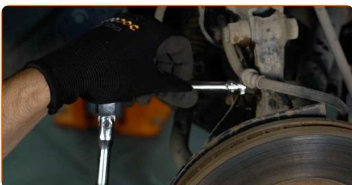
**12** Nettoyez les fixations assurant la connexion entre la jambe d'amortisseur et le porte-fusée. Utilisez une brosse métallique. Servez vous de l'aérosol WD-40.
