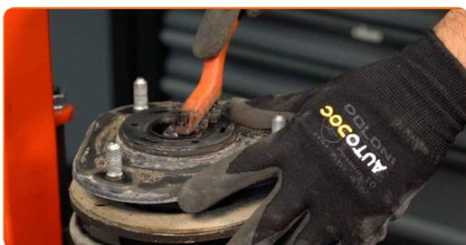
**25** Retirez l'écrou de la tige de piston de l'entretoise. Utilisez une clé à chaîne. Utilisez une douille n° 21. Utilisez une clé à cliquet.
