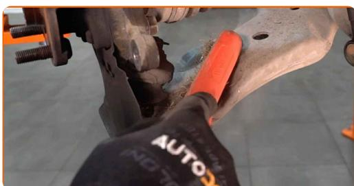
**16** Dévissez les fixations qui lient le joint à rotule au bras de contrôle de suspension. Utilisez une douille n° 17.
