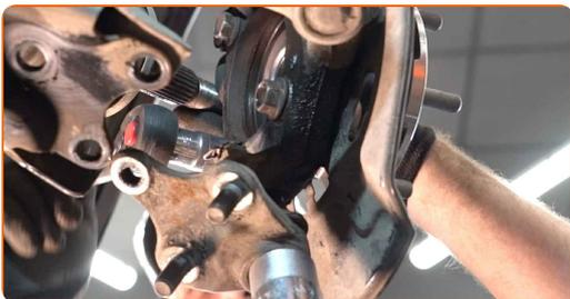
**28** Serrez la fixation du palier de moyeu de roue. Utilisez une douille n° 17. Utilisez une clé dynamométrique. Serrez-le jusqu'à 96 Nm.
