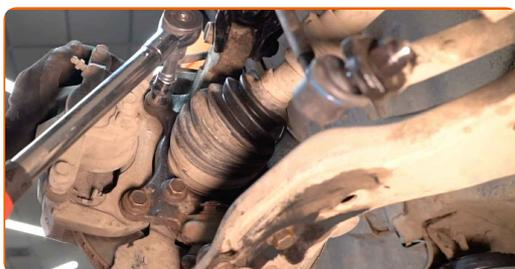
**40** Vissez l'écrou à l'arbre d'entraînement. Utilisez une douille n° 30. Utilisez un porte-taraud.
