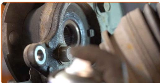
**23** Dévissez le support du roulement de moyeu. Utilisez une douille n° 17. Utilisez un porte-taraud.
