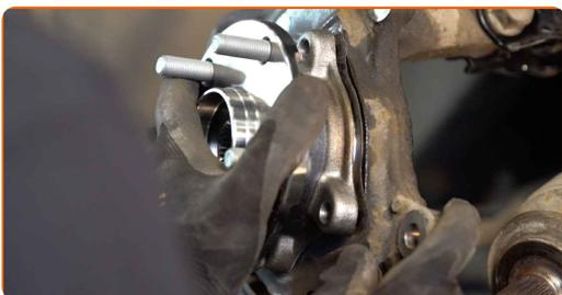
**27** Serrez les attaches du roulement du moyeu de roue. Utilisez une douille n° 17. Utilisez une clé à cliquet.
