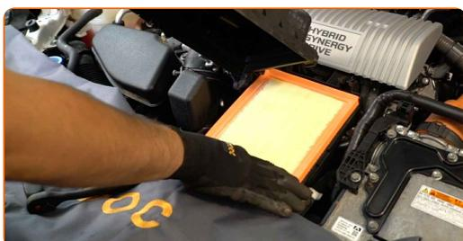
Remplacement : filtre à air – TOYOTA AVENSIS Break (ZRT27, ADT27). AUTODOC recommande :
