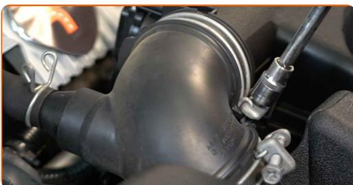
**4** Déverrouillez les clips du couvercle du filtre à air.
