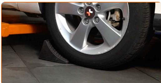
**4** Desserrez les boulons de fixation de la roue. Servez-vous d'une douille à choc pour roue N°21.
