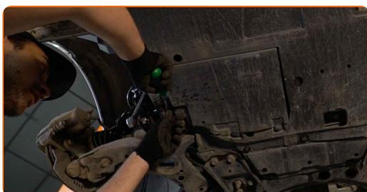
**9** Retirez le carénage sous moteur.
