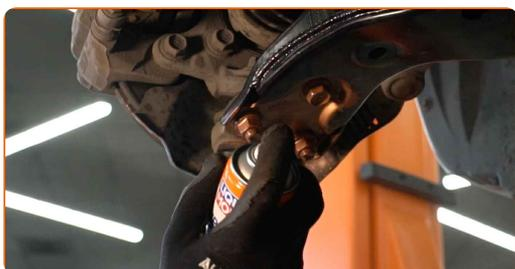
**41** Appliquez du produit sur la zone de contact entre le disque de frein et la jante. Utilisez de la graisse au cuivre.
