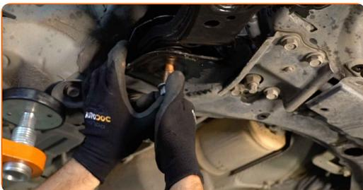
**30** Vissez la fixation arrière reliant le bras de suspension au cadre auxiliaire. Utilisez une clé mixte de No.22. Utilisez une douille n° 22. Utilisez une clé à cliquet.
