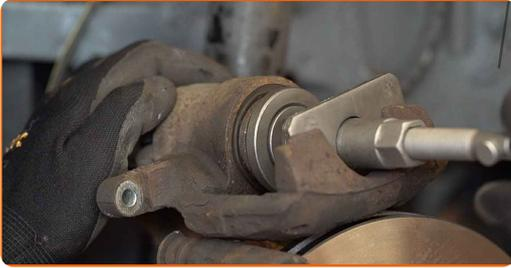
**19** Installez l'étrier de frein et fixez-le. Utilisez une douille n° 13. Utilisez une clé dynamométrique. Serrez-le jusqu'à 30 Nm.
