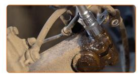
16 Retirez l'écrou de fixation.
