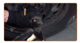
Desserrez la fixation de l'arbre de transmission. Servez-vous d'une douille 12 pans n°30. Utilisez un porte-taraud.
