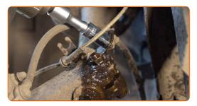
Dévissez la fixation inférieure assurant la connexion entre la jambe d'amortisseur et le porte-fusée. Utilisez une clé mixte de No.17 Utilisez une douille n° 17. Utilisez un porte-taraud.
