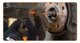
Relâchez la fixation inférieure assurant la connexion entre la jambe d'amortisseur et le porte-fusée. Servez-vous d'un burin plat pour l'usinage des métaux. Servez-vous d'un marteau.
