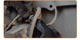
Nettoyez les fixations du capteur ABS et du flexible de frein qui les relient à la jambe d'amortisseur. Nettoyez les fixations assurant la connexion entre la jambe d'amortisseur et le porte-fusée. Utilisez une brosse métallique. Servez vous de l'aérosol WD-40.
