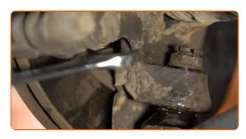
53 Installez l'écrou de fixation.
