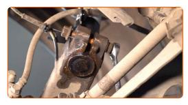
Vissez la fixation qui relie la jambe d'amortisseur à la fusée d'essieu. Utilisez une douille n° 17. Utilisez une clé mixte de No.17.
