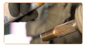
Montez l'arbre de transmission sur le moyeu de roue.
