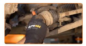
Appliquez du produit sur les cannelures de joint de l'arbre de transmission. Utilisez de la graisse au cuivre.
