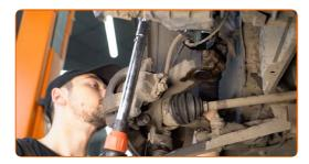
Serrez l'attache du joint rotule. Utilisez une clé mixte de No.19. Utilisez une clé dynamométrique. Serrez-le jusqu'à 98 Nm.
