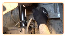
Serrez les fixations inférieures qui relient l'amortisseur à la fusée d'essieu. Utilisez une douille n° 17. Utilisez une clé dynamométrique. Serrez-le jusqu'à 52 Nm.
