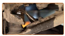
Dévissez l'attache entre le joint rotule et la fusée d'essieu. Utilisez une clé mixte de No.19.
