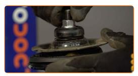
Serrez l'écrou de l'entretoise d'amortisseur due la tige de piston. Utilisez une clé mixte de No.17. Servez vous de la douille XZN n°6. Utilisez une clé dynamométrique. Serrez-le jusqu'à 33 Nm.
