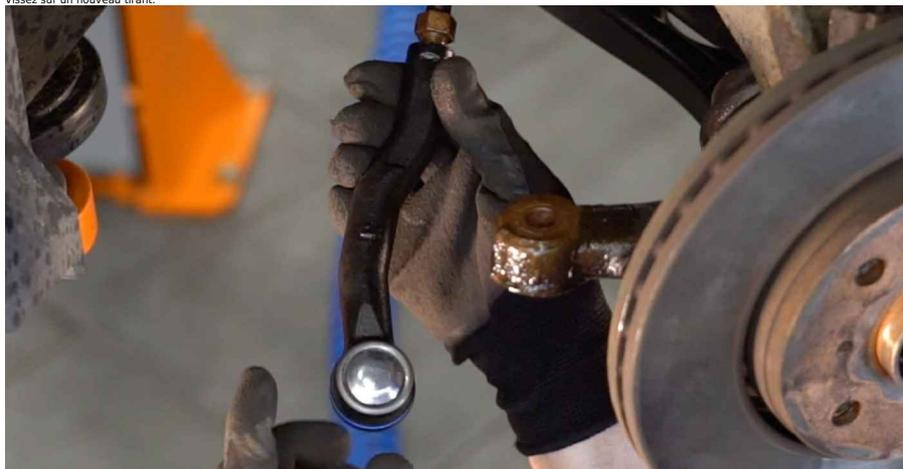
Remplacement : rotule de direction - TOYOTA Aygo (AB40). AUTODOC recommande :
