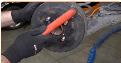
**42** Appliquez du produit sur la surface de contact entre la jante et le tambour de frein. Utilisez de la graisse au cuivre.
