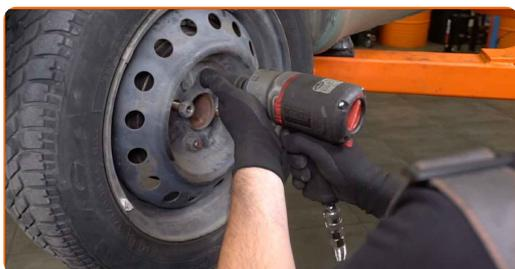
**45** Abaissez la voiture et serrez les boulons de roue en ordre croisé. Servez-vous d'une douille à choc pour roue N°21. Utilisez une clé dynamométrique. Serrez-le jusqu'à 103 Nm.
