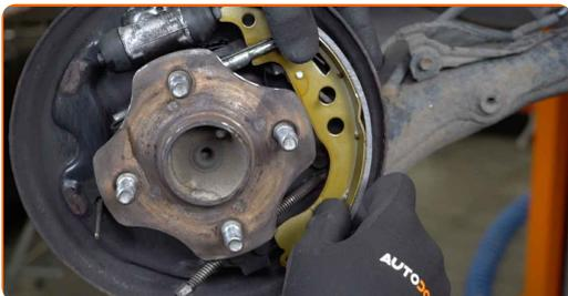
**29** Réinstallez l'axe de retenue de la mâchoire de frein. Utilisez un compresseur de ressort de maintien de mâchoire de frein.
