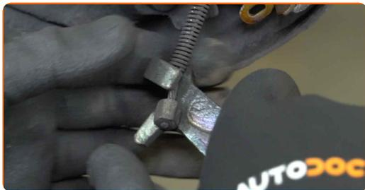
**18** Démontez maintenant le ressort de maintien supérieur ainsi que le mécanisme de réglage.
