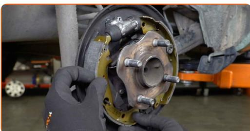
**32** Réinstallez l'axe de retenue de la mâchoire de frein. Utilisez un compresseur de ressort de maintien de mâchoire de frein.
