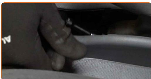
**40** Réinstallez le bouchon de la fixation du câble du frein de stationnement.
