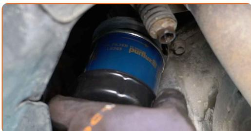
**16** Serrez le filtre à huile. N'oubliez pas de respecter le couple de serrage recommandé. Utilisez la douille 65-14F. Utilisez une clé dynamométrique. Serrez-le jusqu'à 24 Nm.
