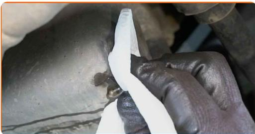
**18** Vissez le nouveau bouchon de vidange et le resserrez. Utilisez une douille n° 14. Utilisez une clé dynamométrique. Serrez-le jusqu'à 30 Nm.
