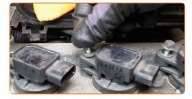
Serrez les fixations des bobines d'allumage. Utilisez une douille n° 10. Utilisez une clé dynamométrique. Serrez-le jusqu'à 9 Nm.
