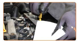
Réinstallez le support du faisceau de câbles.
