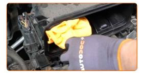
Connectez le tuyau d'admission d'air au boitier du filtre à air.
