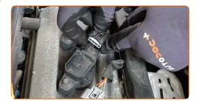
Dévissez les fixations des bobines d'allumage. Utilisez une douille n° 10. Utilisez une clé à cliquet.
