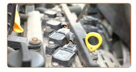
Dévissez les fixations du support du faisceau de câbles. Utilisez une douille n° 10. Utilisez une clé à cliquet.
