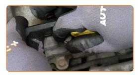
Serrez les fixations du support du faisceau de câbles. Utilisez une douille n° 10. Utilisez une clé dynamométrique. Serrez-le jusqu'à 9 Nm.
