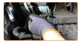
Déconnectez le tuyau d'admission d'air du boitier du filtre à air.
