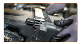
Appuyez sur les attaches du couvercle du filtre à air pour le remettre en place.
