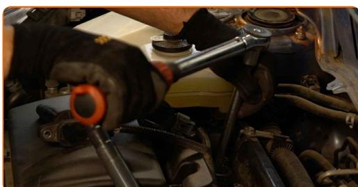
Remplacement : bougies d'allumage – TOYOTA CELICA Décapotable (AT20\_, ST20\_). Les professionnels recommandent :
