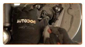
Débranchez les fils du capteur d'ABS.
