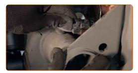
Appliquez du produit à l'endroit où le moyeu de roue entre en contact avec le tambour de frein. Utilisez de la graisse au cuivre.
