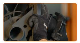
Nettoyez l'emplacement de roulement de moyeu. Utilisez une brosse métallique.
