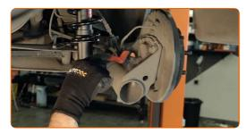
9 Détachez le connecteur du capteur ABS. Utilisez un tournevis plat.
