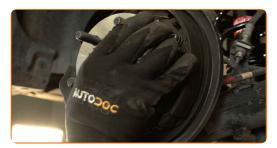
Serrez la fixation du palier de moyeu de roue. Utilisez une douille n° 10. Utilisez une clé dynamométrique. Serrez-le jusqu'à 61 Nm.
