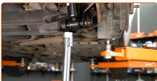
**31** Serrez l'attache inférieure de l'amortisseur. Utilisez une clé mixte de No.17 Utilisez une douille n° 17. Utilisez une clé dynamométrique. Serrez-le jusqu'à 75 Nm.
