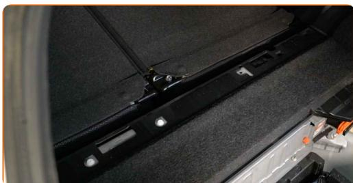
**8** Dévissez la fixation du panneau de protection central en plastique. Utilisez une douille n° 10. Utilisez une clé à cliquet.
