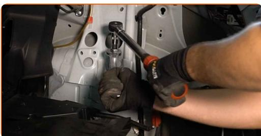
**40** Nettoyez les fixations de l'amortisseur. Utilisez de la graisse au cuivre.
