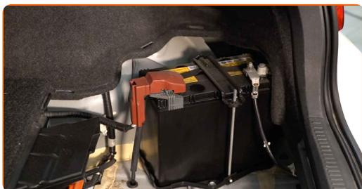
**6** Retirez les attaches de la garniture avant inférieure du coffre.
