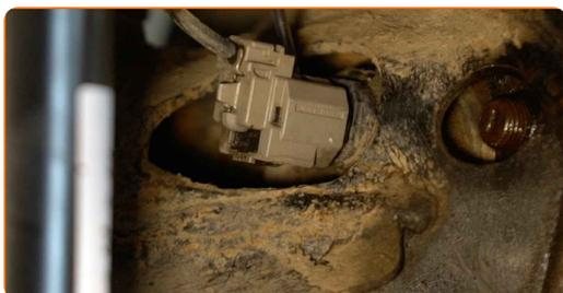
**20** Débranchez les fils du capteur d'ABS.
