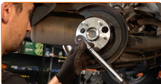
Remplacement : roulement de roue – TOYOTA Corolla Berline (\_E18\_, ZRE1\_).
