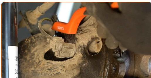
**19** Détachez le connecteur du capteur ABS. Utilisez un tournevis plat.
