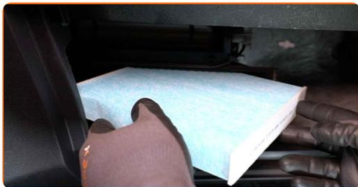
Remplacement : filtre d'habitacle – TOYOTA COROLLA Break (\_E12J\_, \_E12T\_). Les professionnels recommandent :
