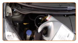
Remplacement : huile moteur et filtre à huile – TOYOTA Corolla Levin Coupe (E100). Les professionnels recommandent :
