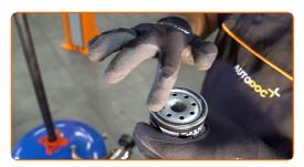
Vissez le filtre neuf en place. Utilisez la douille 76/14-F. Utilisez une clé dynamométrique. Serrez jusqu'à 23 Nm.
