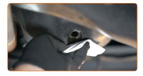
Vissez le nouveau bouchon de vidange et le resserrez. Utilisez une douille n° 15. Utilisez une clé dynamométrique. Serrez jusqu'à 27 Nm.
