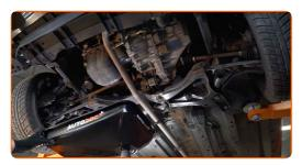
Dévissez le bouchon de vidange. Utilisez une douille n° 15. Utilisez une clé à cliquet.
