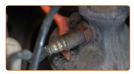
Dévissez la fixation de la sonde lambda. Utilisez une clé polygonale ouverte #22. Utilisez une clé à cliquet.
