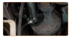
Appliquez du produit sur le connecteur de la sonde lambda. Utilisez de la graisse diélectrique.
