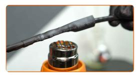
Appliquez du produit sur le filetage de la nouvelle sonde lambda. Utilisez du lubrifiant céramique à haute température.
