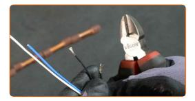
Placez la gaine thermorétractable sur le câblage de la sonde lambda.
