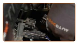
Détachez le collier de serrage pour libérer le faisceau de câbles de la sonde lambda. Utilisez un tournevis plat.
