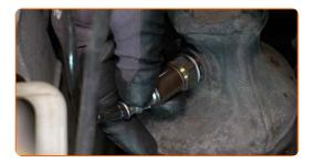
Serrez la fixation de la sonde lambda. Utilisez une douille à sonde lambda de 22 mm. Utilisez une clé dynamométrique. Serrez-le jusqu'à 40 Nm.
