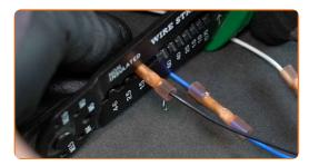
Rétractez les gaines thermorétractables des manchons à souder. Utilisez un pistolet thermique.
