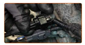
Fixez le câblage de la sonde lambda avec le collier de serrage.
