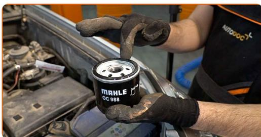
**19** Vissez le filtre neuf en place. Utilisez la douille 76-14F. Utilisez une clé dynamométrique. Serrez-le jusqu'à 20 Nm.
