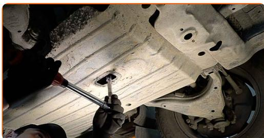
**15** Resserrez le bouchon de remplissage d'huile. Utilisez une douille n° 17. Utilisez une clé dynamométrique. Serrez-le jusqu'à 30 Nm.
