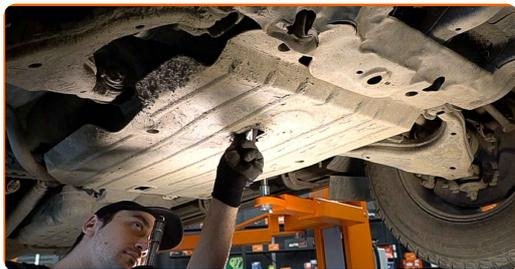
**14** Vissez un nouveau bouchon de remplissage d'huile. Utilisez une douille n° 17. Utilisez une clé à cliquet.
