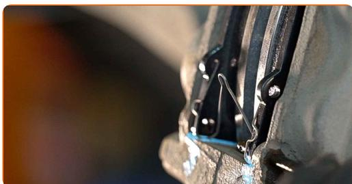
**18** Installez les clips de retenue des plaquettes de frein.
