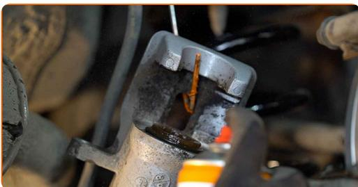
Remplacement : plaquettes de frein – TOYOTA Matrix II 3/5 portes (E140).
