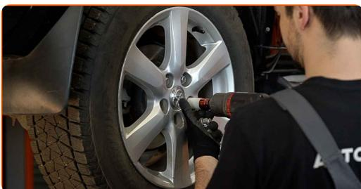
Remplacement : plaquettes de frein – TOYOTA Matrix II 3/5 portes (E140). Les experts d'AUTODOC recommandent :
