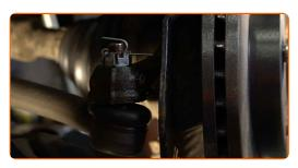
Serrez l'écrou de bloquage de l'extrémité de la barre. Utilisez une clé mixte de No.15 Utilisez une clé mixte de No.19 Utilisez une clé dynamométrique. Serrez-le jusqu'à 74 Nm.
