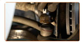
Serrez l'écrou de fixation reliant l'embout de biellette de direction à la fusée d'essieu. Utilisez une douille n° 19. Utilisez une clé dynamométrique. Serrez-le jusqu'à 49 Nm.
