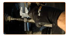
Déserrez l'écrou de bloquage qui retient l'extrémité de la barre stabilisatrice à la barre stabilisatrice. Utilisez une clé mixte de No.19
