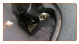
Déposer les éléments du support supérieur de l'amortisseur.
