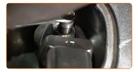
Appliquez du produit sur la fixation supérieure de l'amortisseur. Utilisez de la graisse au cuivre.
