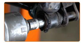
12 Retirez l'écrou de fixation.
