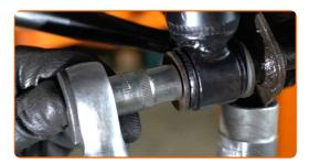
Traitez la fixation inférieure de l'amortisseur. Utilisez de la graisse au cuivre.
