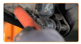
Dévissez l'attache inférieure de l'amortisseur. Utilisez une douille n° 14. Utilisez une clé à cliquet.
