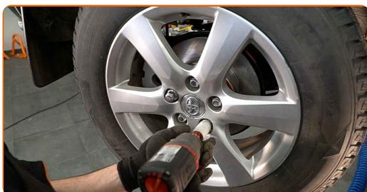
**31** Abaissez la voiture et serrez les boulons de roue en ordre croisé. Utilisez une clé dynamométrique. Serrez-le jusqu'à 103 Nm.
