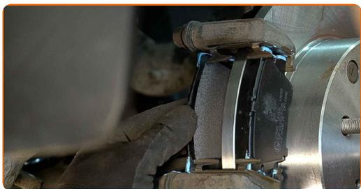
**26** Installez l'étrier de frein et fixez-le. Utilisez une douille n° 14. Utilisez une clé dynamométrique. Serrez-le jusqu'à 27 Nm.
