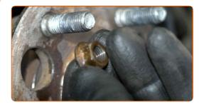
Dévissez les fixations qui lient l'arbre de transmission au moyeu de roue. Utilisez une douille n° 30. Utilisez une clé à cliquet.
