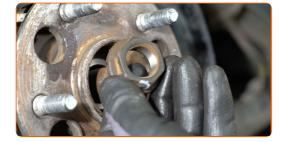
Retirez le roulement du moyeu de la roue.
