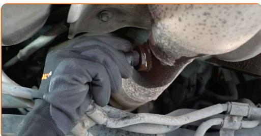
**8** Appliquez du produit sur la sonde lambda. Utilisez du lubrifiant céramique à haute température.
