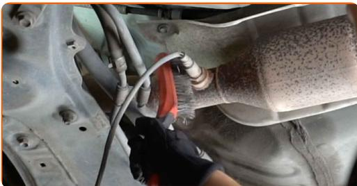
**4** Dévissez la fixation de la sonde lambda. Utilisez une douille à sonde lambda de 22 mm. Utilisez une clé à cliquet.
