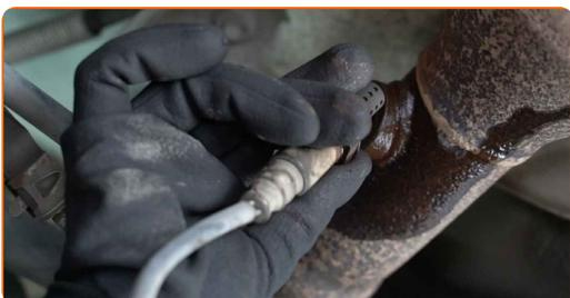
**7** Faire un taraudage pour la nouvelle sonde lambda. Utilisez un taraud. Utilisez une clé à cliquet.
