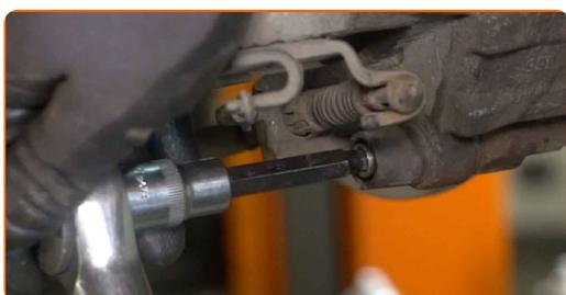
**43** Installez les bouchons anti-poussière des goupilles de guidage de l'étrier de frein.
