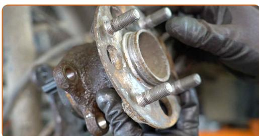
**24** Nettoyez l'emplacement de roulement de moyeu. Utilisez une brosse métallique. Servez-vous d'un aérosol nettoyant multi-usages.
