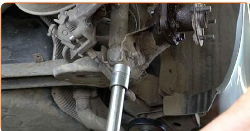
**21** Dévissez les fixations du roulement du moyeu de la roue. Utilisez une douille n° 14. Utilisez une clé à cliquet.
