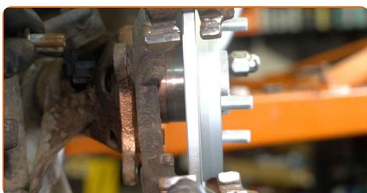
**37** Installez les boulons de fixation.
