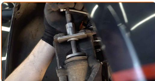
**28** Installez l'étrier de frein et fixez-le. Utilisez une clé mixte de No.17. Utilisez une douille n° 14. Utilisez une clé dynamométrique. Serrez-le jusqu'à 35 Nm.
