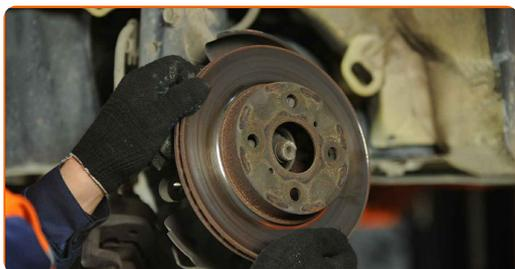
**16** Nettoyez le moyeu. Utilisez une brosse métallique. Traitez la surface de contact. Utilisez de la graisse au cuivre.
