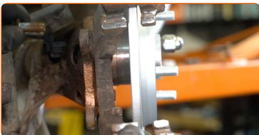
**37** Installez les boulons de fixation.
