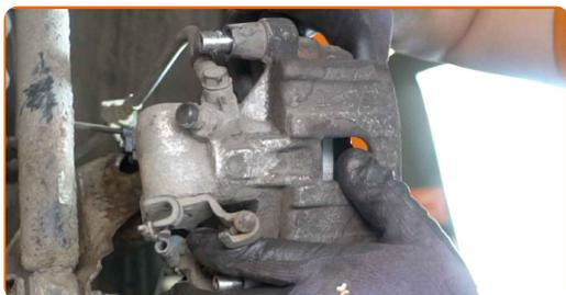
**42** Serrez les fixations de l'étrier de frein. Utilisez la clé HEX n° H7. Utilisez une clé dynamométrique. Serrez-le jusqu'à 34 Nm.
