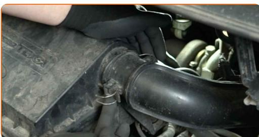
**4** Déconnectez le tuyau d'admission d'air du boîtier du filtre à air.
