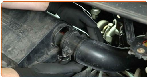
**5** Détachez les clips du couvercle du filtre à air.
