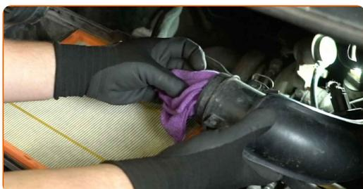
**8** Retirez l'élément filtrant du boîtier du filtre.
