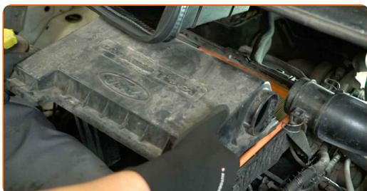
**7** Branchez le tuyau d'admission d'air à l'aide d'un chiffon en microfibre afin d'éviter la pénétration de poussière et de saleté dans le système.
