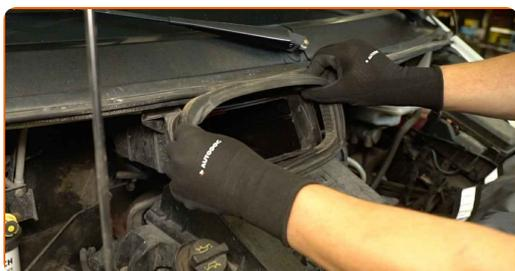
**6** Installez un nouveau filtre dans le boîtier. Vérifiez les marques sur le bord du filtre afin de vous assurer de l'installer dans le bon sens.
