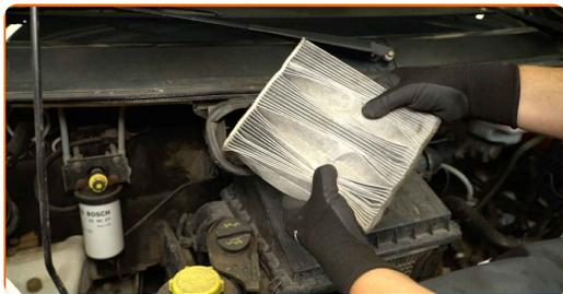
**4** Fermez le conduit d'air en utilisant une serviette propre et nettoyez l'intérieur du boîtier du filtre d'habitacle. Utilisez une serviette en microfibre.
