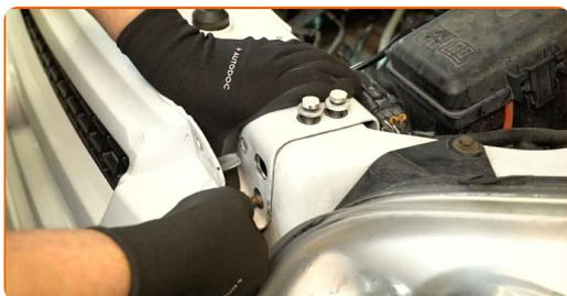
**42** Serrez les fixations du couvercle supérieur du support du radiateur. Utilisez une douille d'entraînement de 13 mm. Utilisez une clé dynamométrique. Couple de serrage : 22 Nm.
