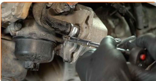
**9** Détachez le tuyau de liquide de refroidissement du refroidisseur d'huile.
