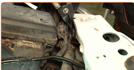
**19** Détachez le réservoir de liquide de direction assistée.
