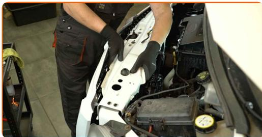
**41** Installez et vissez les boulons de fixation du couvercle supérieur du support du radiateur.
