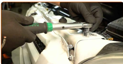
**43** Installez et vissez les fixations supérieures de la grille du radiateur. Utilisez un embout Torx T30. Utilisez une clé à cliquet.
