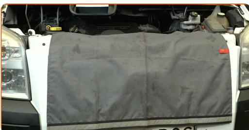
**3** Dévissez le bouchon du réservoir de liquide de refroidissement.
