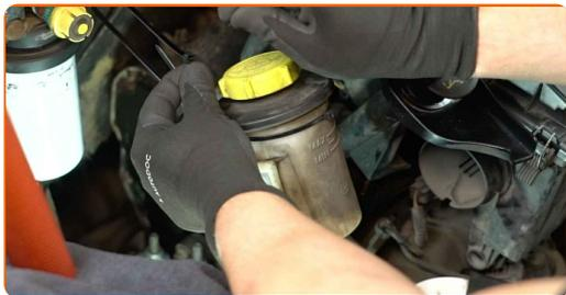
**20** Desserrez le collier de serrage du tuyau inférieur du liquide de refroidissement. Utilisez une pince à collier de serrage.
