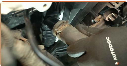
**49** Traitez le connecteur du ventilateur de refroidissement du moteur. Utilisez une bombe pour contacts électriques.
