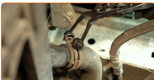
**21** Détachez le tuyau inférieur du liquide de refroidissement.
