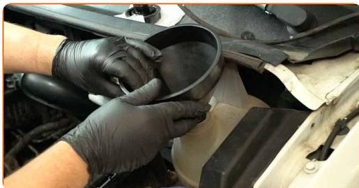
**53** Versez le liquide de refroidissement dans le réservoir.
