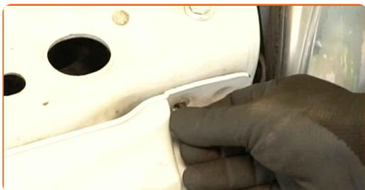
**24** Dévissez les fixations du couvercle du support supérieur du radiateur. Utilisez une clé mixte de 13 mm. Utilisez une douille d'entraînement de 13 mm. Utilisez une clé à cliquet.
