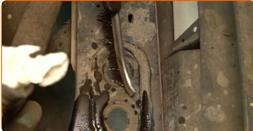
**32** Installez les isolateurs inférieurs du radiateur.
