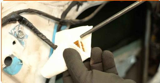
**27** Raccordez le connecteur au commutateur de la vitre électrique.
